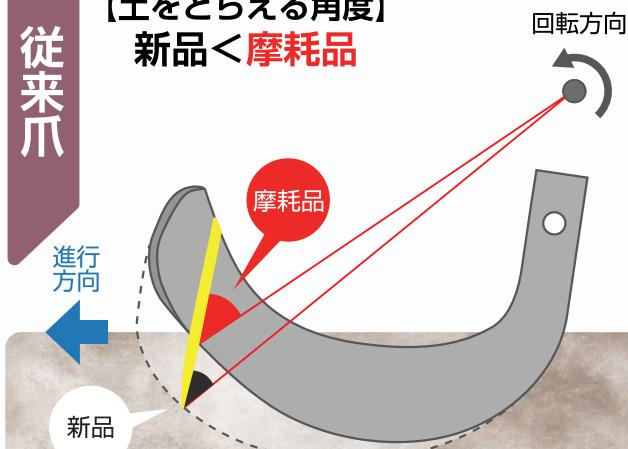
従来爪の形状は爪幅が少なくなると、土へ打ち込む際の黄色いラインの角度が大きくなるため、土をとらえる力が弱くなり、反転性能が低下する
