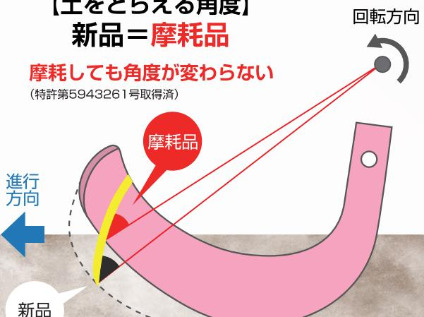
桜SP爪(桜爪)の形状では爪幅が少なくなっても土へ打ち込む際の黄色いラインの角度が一定であるため、しっかりと土をとらえ続けて反転性能を維持する
